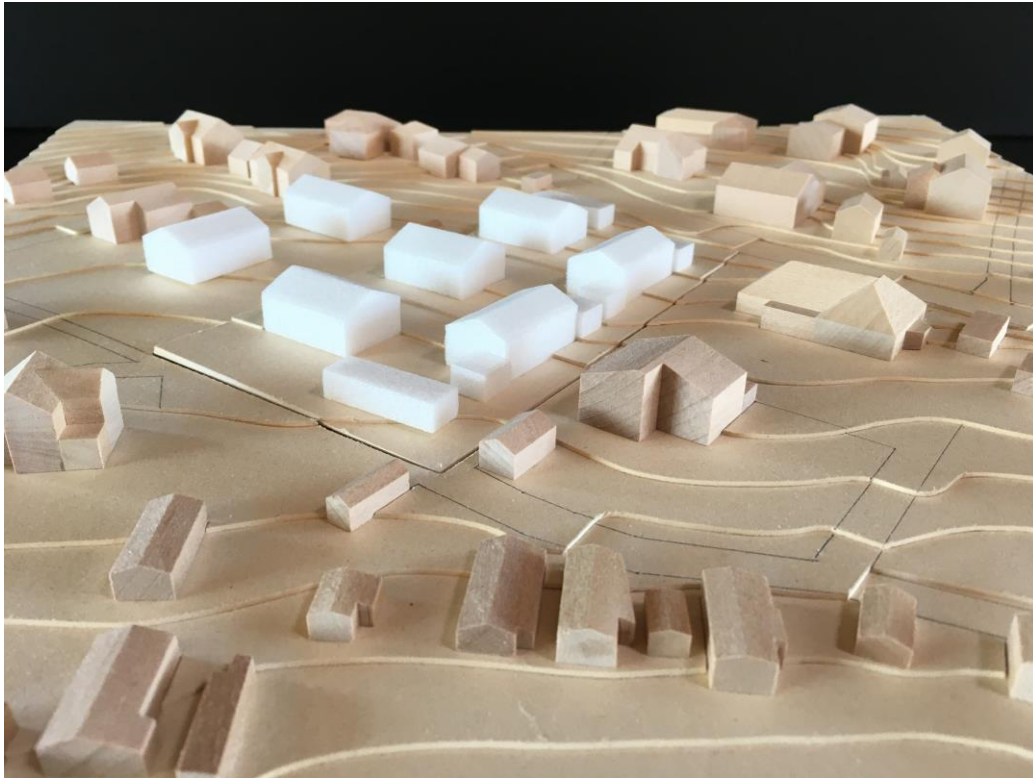
Einsatzmodell im Maßstab M 1:500 für die Bebauungsvariante mit fünf zweigeschossigen Satteldachhäusern
